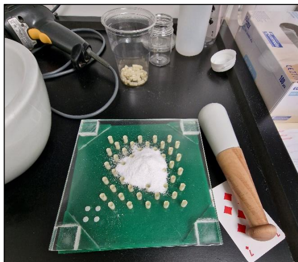
Figure 3.2.2 : Introduction de la préparation dans les gélules
